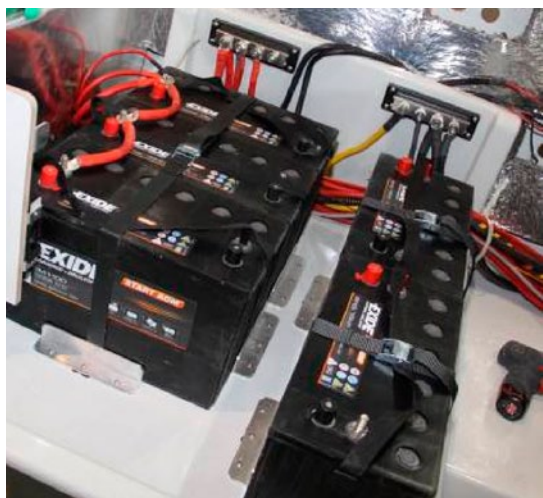
Eksempel på montering av en batteribank med kraftige AGM-batterier.
